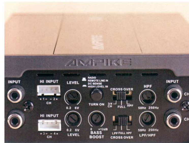
Gewappnet: Die große Filtersektion ermöglicht die gängigen Anlagenkonfigurationen.
