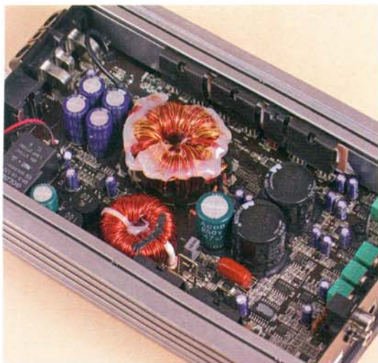
Vorbildlich: Dank Digitaltechnik verbrauchen die Ampire-Verstärker nur wenig Strom und produzieren auch kaum Abwärme.
